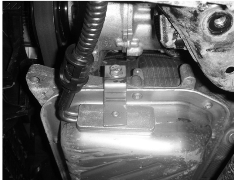
Monterad värmare utan klimatkompressorfäste. Heater mounted without climate compressor bracket. Motorvorwärmer montiert ohne Klimaanlage Kompressor Halterung. Lämmitin asennettu ilman kompressorin kiinnikettä.
