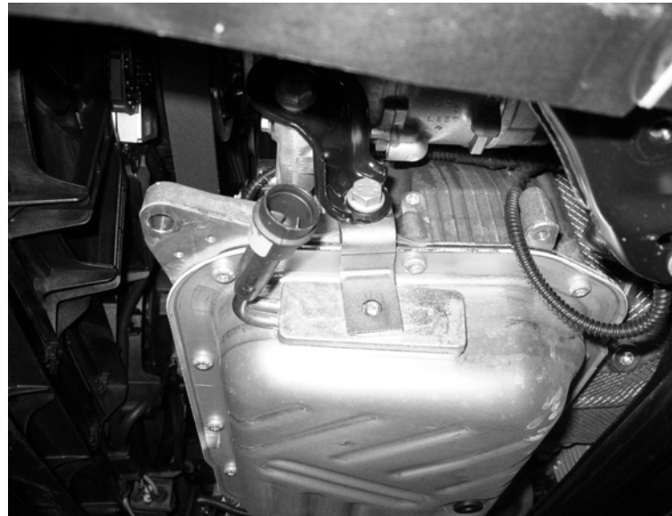
Monterad värmare med klimatkompressorfäste. Heater mounted with climate compressor bracket. Motorvorwärmer montiert mit Klimaanlage Kompressor Halterung. Lämmitin asennettu kompressorin kiinnikkeellä.
