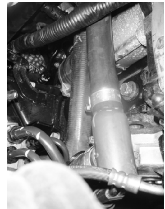
Värmare med slangar monterad (bild tagen underifrån) Heater with hoses, mounted (picture taken from below) Motorvorwärmer mit montierten Schläuchen (Bildansicht von unten)
