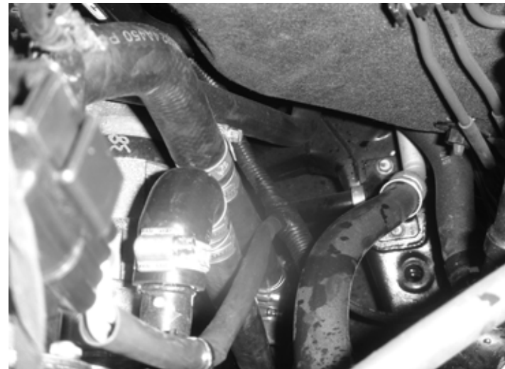
Värmare med slangar monterad (bild tagen upifrån) Heater with hoses, mounted (picture taken from above) Motorvorwärmer mit montierten Schläuchen (Bildansicht von oben)
