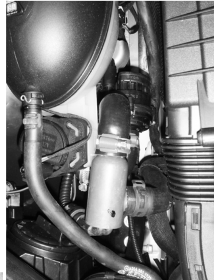
Värmare med slangar monterad. Heater with hoses, mounted. Motorvorbärer mit montierten Schläuchen.
